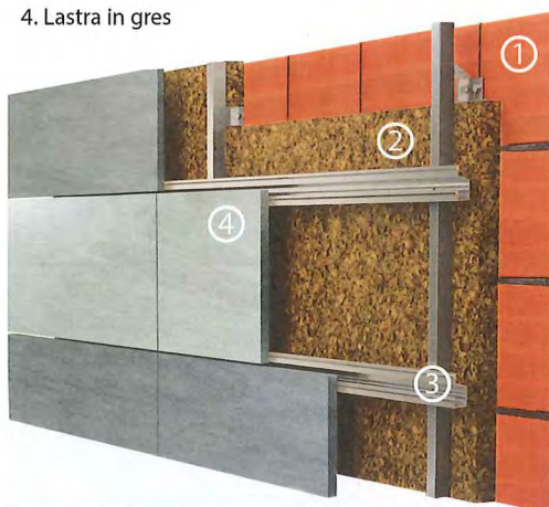
1. Stratigrafia di una parete ventilata
