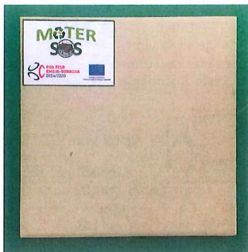
Piastrella ceramica (prototipo di laboratorio 10x10 cm) contenente oltre il 60% di rifiuti e sinterizzata a circa 100°C in meno rispetto alle piastrelle tradizionali di gres porcellanato
