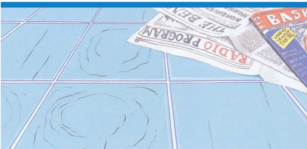
■ Il cavillo è una **sottile lesione superficiale dello smalto**, la cui origine è da ricondurre a **problemi di disaccordo dilatometrico fra smalto e supporto**, ed anche a **variazioni dimensionali delle piastrelle** - soprattutto di quelle a supporto poroso / (monoporosa) - in condizioni di umidità e temperatura elevate; a seguito di tali circostanze lo smalto viene sottoposto a una sollecitazione di trazione, sufficientemente elevata da produrre le sottili lesioni in esame.
