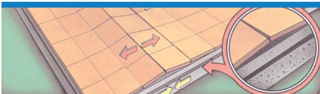
■ Il sollevamento avviene spesso **improvvisamente, anche se preannunciato da segni premonitori di entità moderata**. Ad esempio, una porta che non si chiude più; segni di deformazione e/o frantumazione di fughe; sonorità per percussione.
