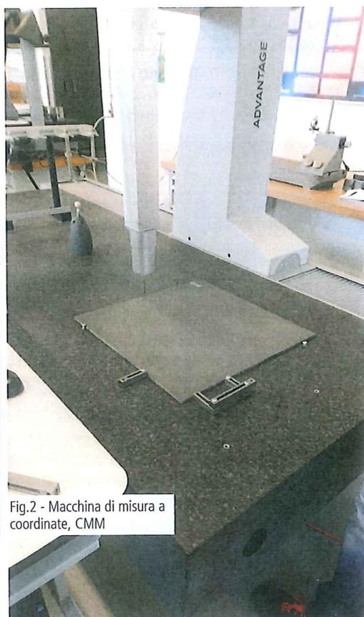
Fig. 2 - Macchina di misura a coordinate, CMM
