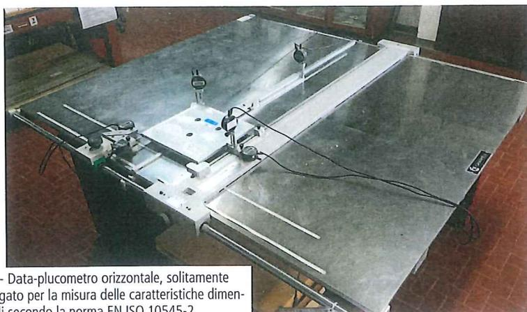
Fig. 1 - Data-plucometro orizzontale, solitamente impiegato per la misura delle caratteristiche dimensionali secondo la norma EN ISO 10545-2.
